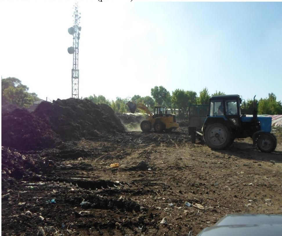
Рис. 1. Штаблеукладчик, оборудованный ковшем объемом 2 м<sup>3</sup> для периодического перемешивания компоста
