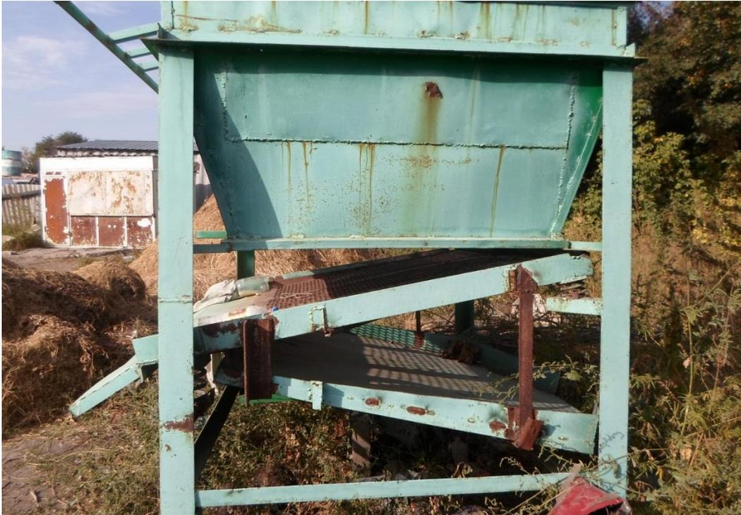
Рис.2. Вибросито трехступенчатое для фракционирования готового компоста.
