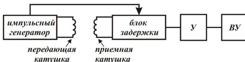
Рис. 3. Принципиальная схема импульсного ТИ
