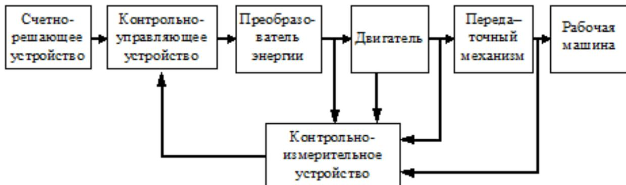
На рис. 2 представлена схема под названием функциональная схема машины автоматического действия, с помощью которой можно провести сравнительный анализ электропривода с гидроприводом [4].
