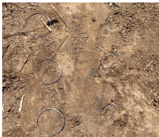
Рисунок 3 - Отбор проб грунта методом режущего кольца
