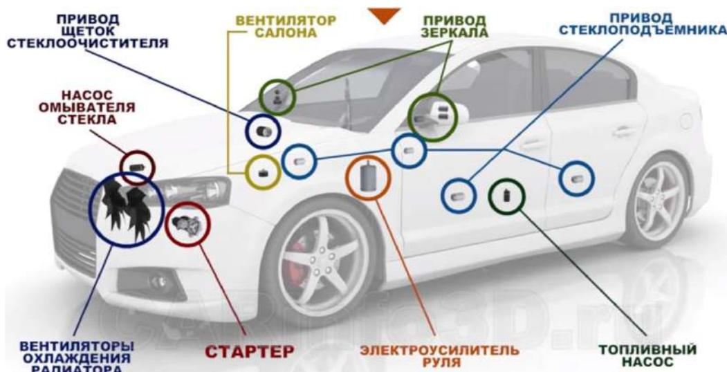
Рисунок 1 - Электроприводы современного автомобиля
