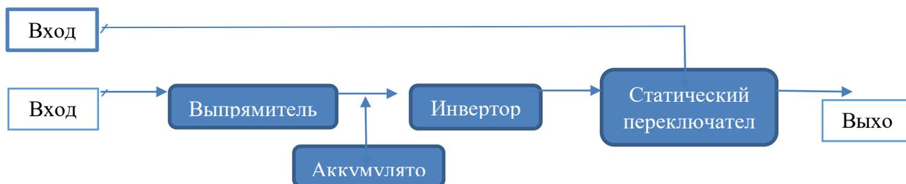
Рисунок 1 - Структурная схема преобразователя
