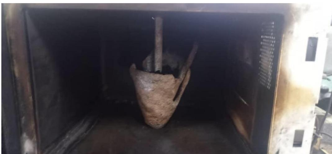
Рис.3. Фотография резонаторной камеры и реакционной установки
