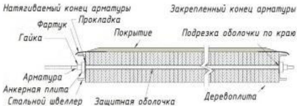
Рис. 2. Конструкция предварительно напряженной многослойной древесины, поперечное сечение
