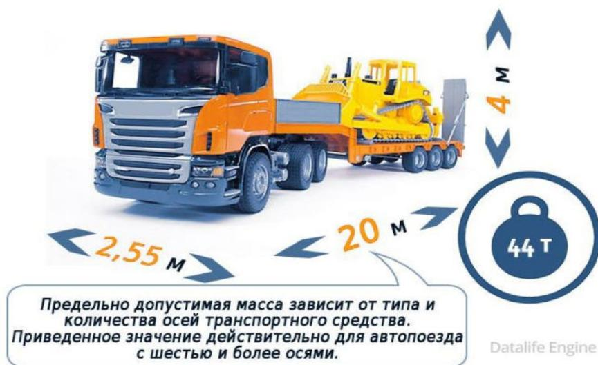
Рис.2. Допустимые ПДД габариты перевозимого груза
