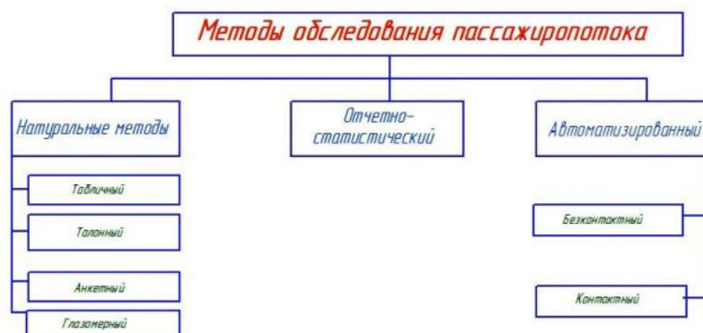
Рис.1. Методы обследования пассажиропотоков автобусного транспорта
