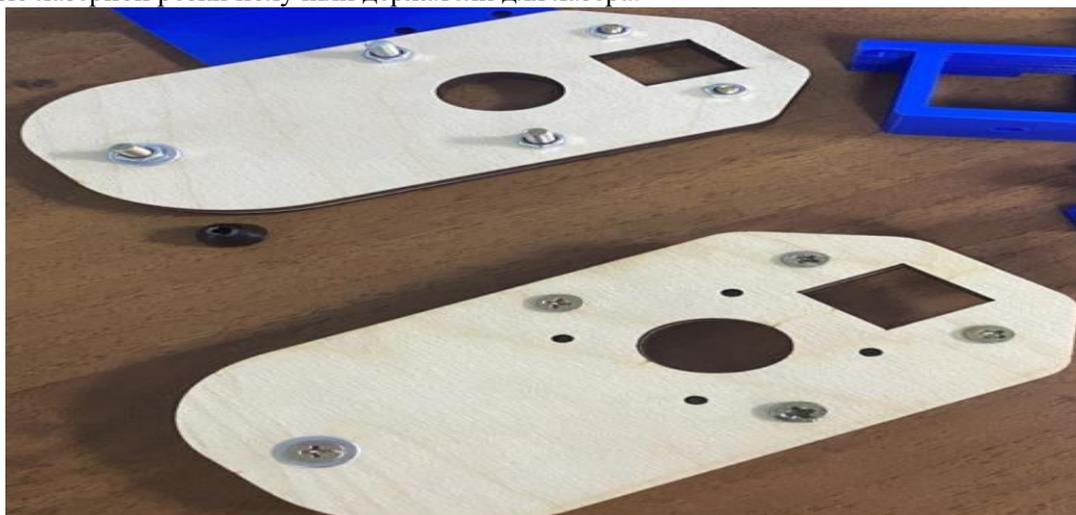
Рис. 2. Держатели для лазера с помощью лазерной резки
