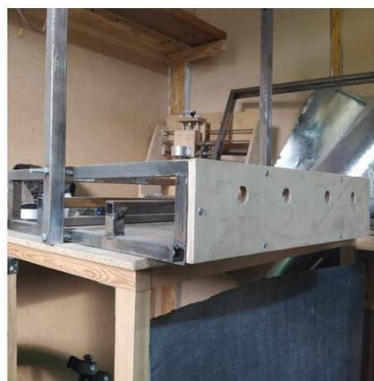
Рама изготовлена из металлической профильной трубы, служит станиной для данной установки.
