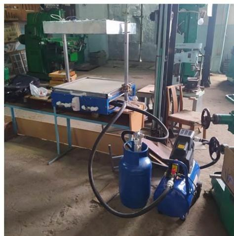
Вакуумная формовка — это производственный метод изготовления изделий из пластика. Во время процесса вакуумной формовки листовой пластик нагревается, а затем за счет всасывания вытягивается вокруг формы, облекая ее поверхность.
