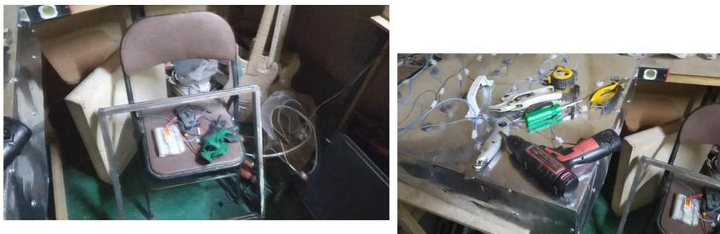
Зажимная рамка изготовлена из металлической профильной трубы, служит для фиксации материала, короб нагревательных элементов изготовлен из металлической профильной трубы и обшит листом оцинковки в нем находятся галогенные лампы, которые и разогревают материал.
