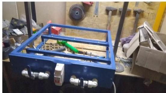
После покраски к устройству подключаются компрессор и вакуумный ресивер изготовленный из газового баллона на 27 литров.
