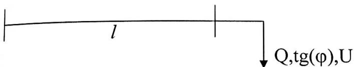
2. Определить потерю напряжения в кабельной линии АПВ длиной 50м, сечением 25 мм<sup>2</sup>, если потребляемая мощность приемника составляет  $P_{oe} = 28 \text{ кВт}$ ,  $\cos\varphi_{nom} = 0,9$ .
