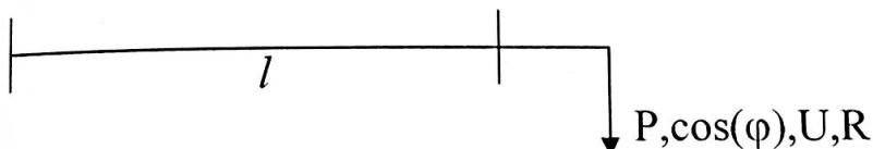
2. Сделать расчет освещения (определить количество и мощность ламп) методом удельной мощности для горячего цеха площадью  $S = 10 \cdot 6 = 60 \text{ м}^2$ , высотой  $H = 3,5 \text{ м}$ . Напряжение электрической сети 220 В;  $h = 2,2 \text{ м}$ , устанавливаемый светильник НСП17-200-103 .
