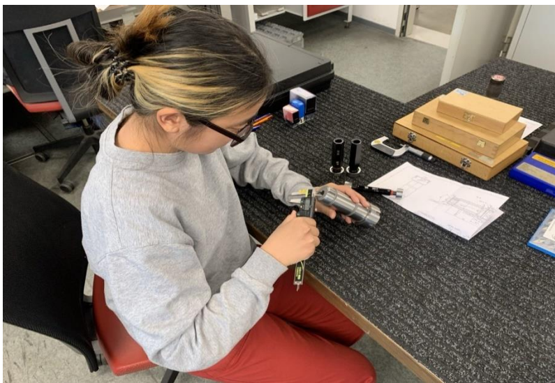
Рис. 1. Контроль точности размеров и параметров резьбы при помощи штангенциркуля и резьбового калибра
