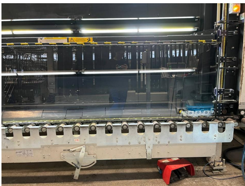
Процесс установки рам на стекло
