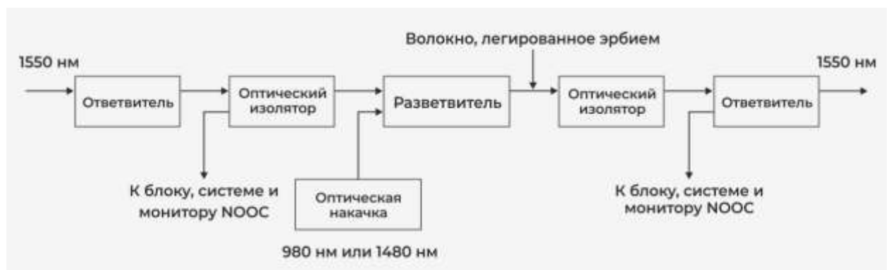
Рис. 13. Принципиальная схема EDFA.
