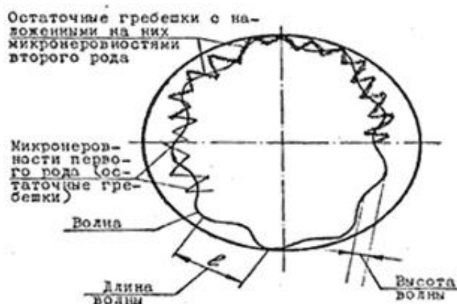
Рис.2. Овальность, волнистость и шероховатость (микронеровностей первого и второго рода) цилиндрической поверхности.
