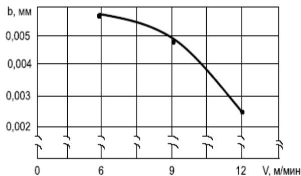
Рис. 5. Зависимость интенсивности изнашивания уголков от скорости резания
