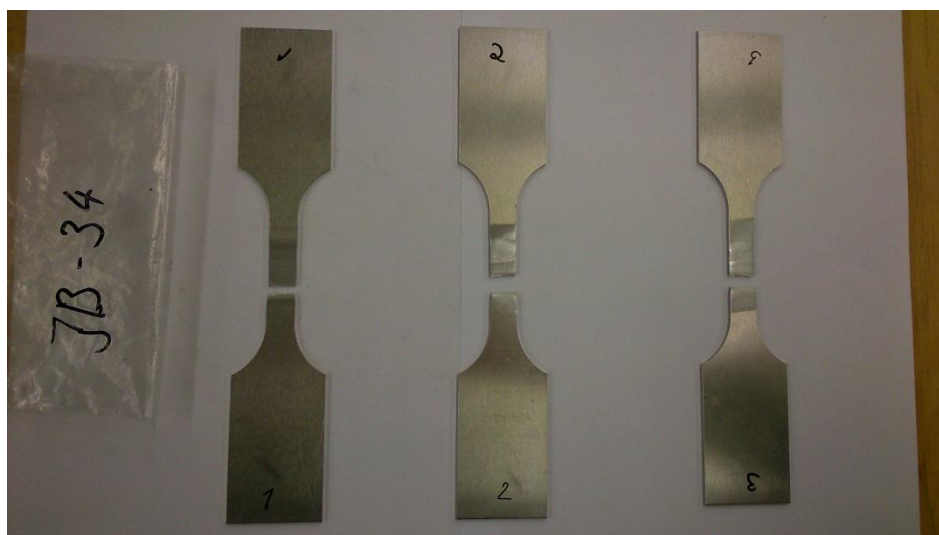
Рис. 1. Образцы сварных листов рабочего участка, вырезанный из сварного соединения для испытания на растяжение
