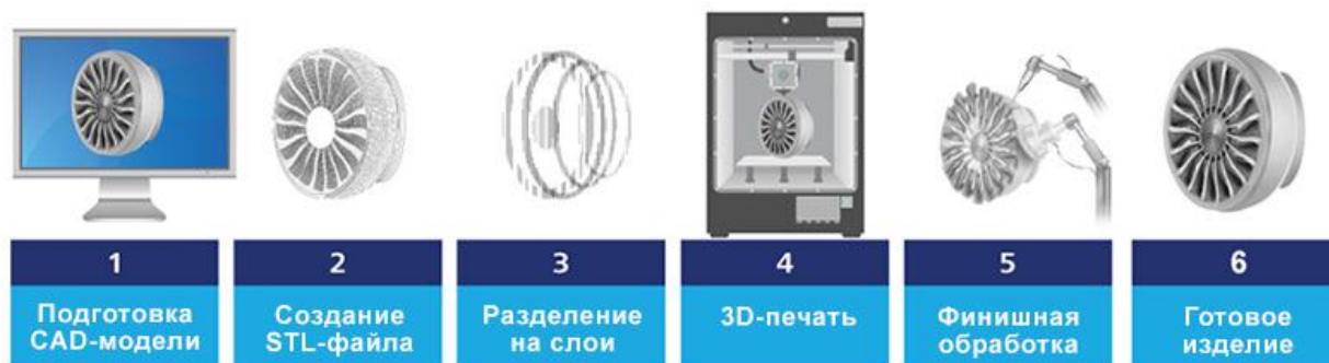
Рис.2. Поэтапное изготовление Аддитивного производства. [3]
