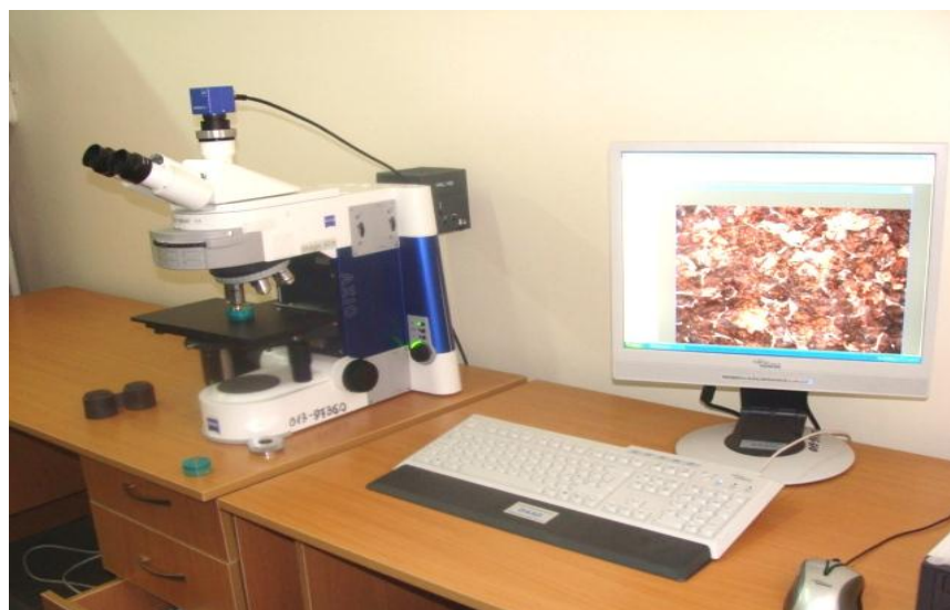
Рис.1. Лаборатория металлографического анализа, общий вид микроскопа Axio Imager A1m/M1m.
