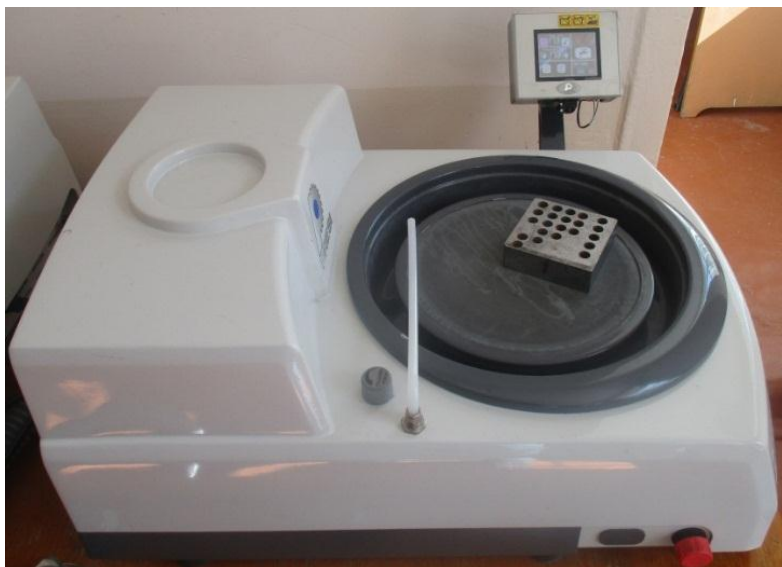
Рис.2. Minitech 233— ручная ододисковая шлифовально-полировальная машина с варьируемой скоростью вращения.
