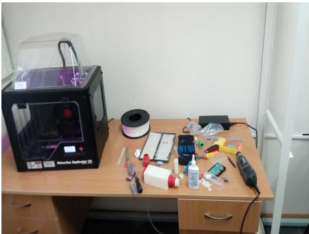
Рис.1.8. Готовые детали регулятора (а) и инструменты для очистки от суппортов и склейки деталей (б).
