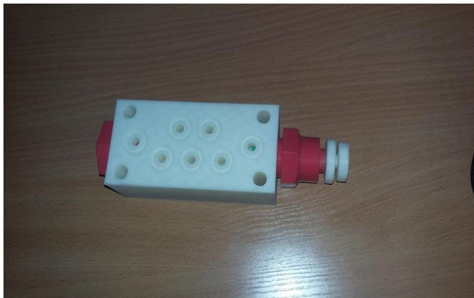
Рис.1.10. Пластмассовая модель регулятора в сборе.
