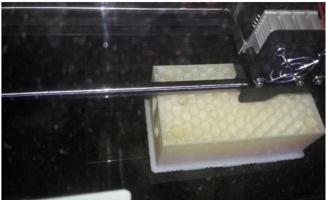
Рис.1.7. Процесс печатания корпуса регулятора на 3D принтере.
