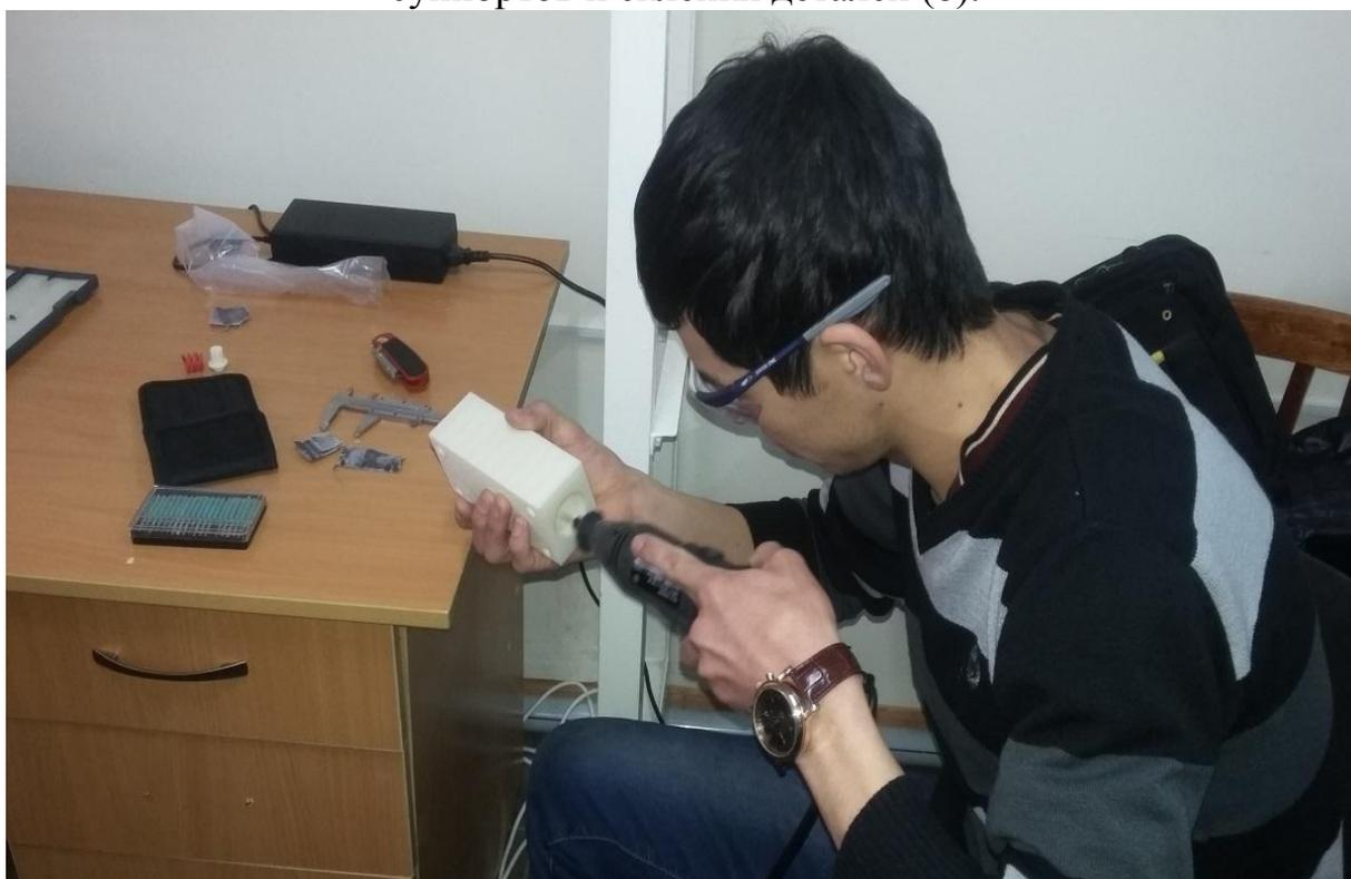
Рис. 1.9. Очистка от суппортов и полировка деталей.
