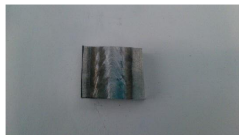
Рис.14.6.Сваренный образец алюминия АW6082
