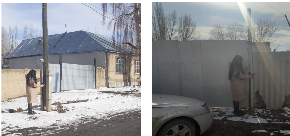
Рисунок 2 - Процесс топографической съемки земельного участка с GNSS приемником марки CHCNAV i73
