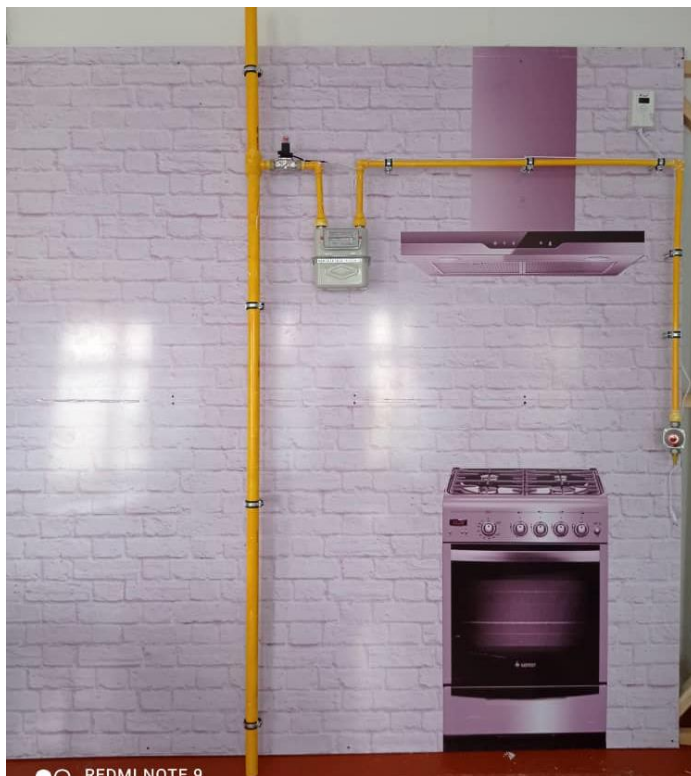
Лабораторная установка «Эксплуатация систем внутреннего газоснабжения с использованием газосигнализаторов» (ОсОО «Централ Азия Технолоджи Йа Тай» ТНРВ)
