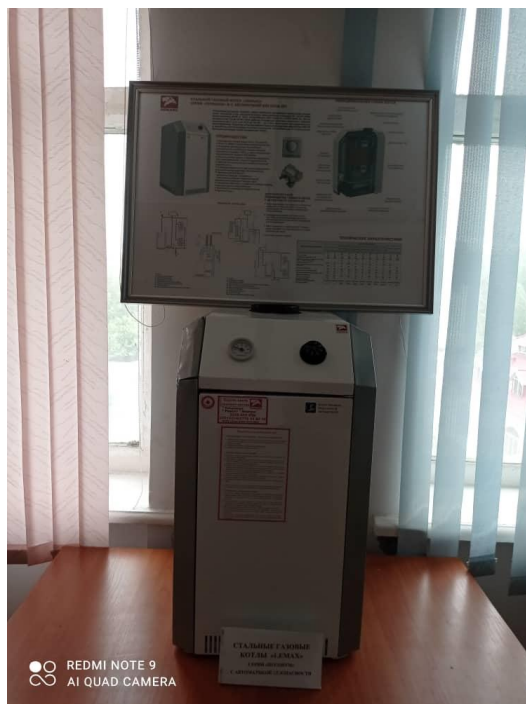
Лабораторная установка Современный газовый котел с системой автоматики со стендом (ОсОО «Азия логистик плюс»)
