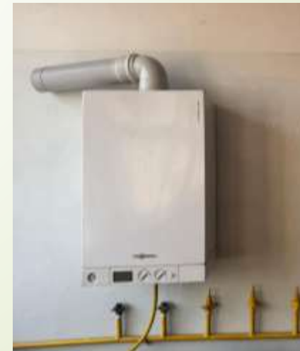
Лабораторная установка «Современный газовый котел с системой автоматики со стендом»
