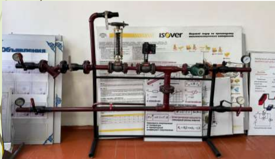
«Тепловой пункт системы теплоснабжения»
