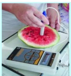
Рисунок 7 - измерение нитратов экспресс методом
