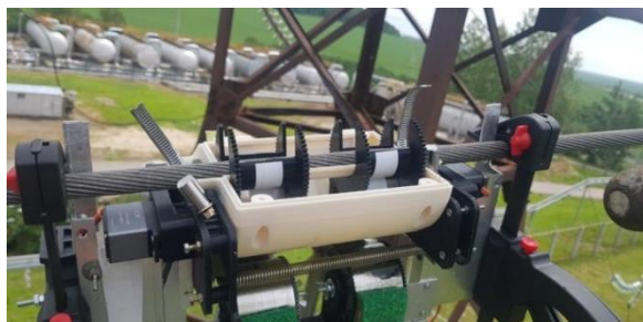
Рис. 2. Капсула с датчиками
