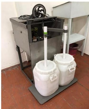
Рисунок 1. Экспериментальный стенд установки для производства «Кымыз»
