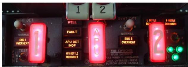
Рисунок 2. Панель сигнализации и тушения пожара двигателей самолета BOEING 737 NG/MAX
