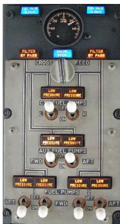
Рисунок 1. Панель управления топливной системы самолета BOEING 737 NG/MAX
