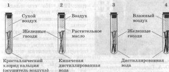
Рис. 122. Коррозия железа в различных условиях
