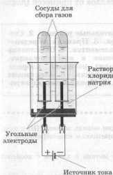
Рис. 114. Схема установки для электролиза раствора хлорида натрия в лаборатории
