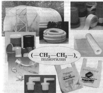
Рис. 79. Благодаря термопластичности из полиэтилена можно получить изделия различной формы
