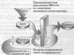
Рис. 108. Схема промышленного получения аммиака
