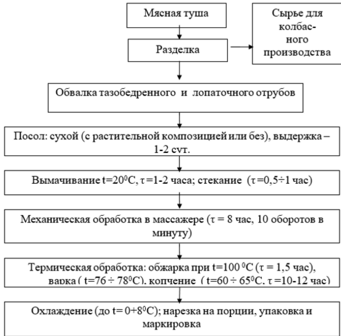
Рис. 14 - Технологическая схема производства цельномышечного варено-копченого продукта из мяса яков
