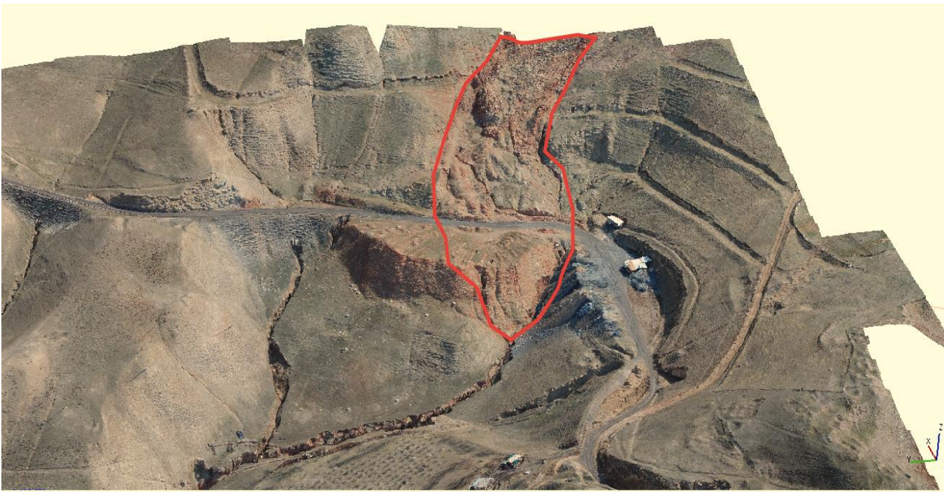
Оседание, оползень и провал земной поверхности над угольной шахтой 4
