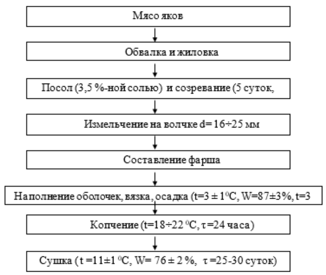
Рис. 15 - Технологическая схема производства варено-копченой колбасы из мяса яка
