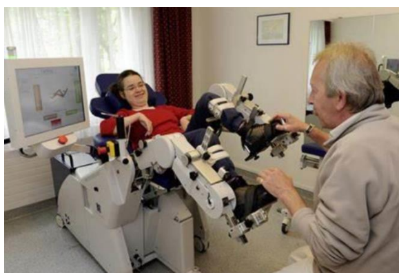
Рисунок 1.4: MotionMaker — робот для реабилитации нижних конечностей в сидячем положении
