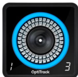
Рисунок 4.1. Камера захвата движения Prime13 и маркеры (mark)
