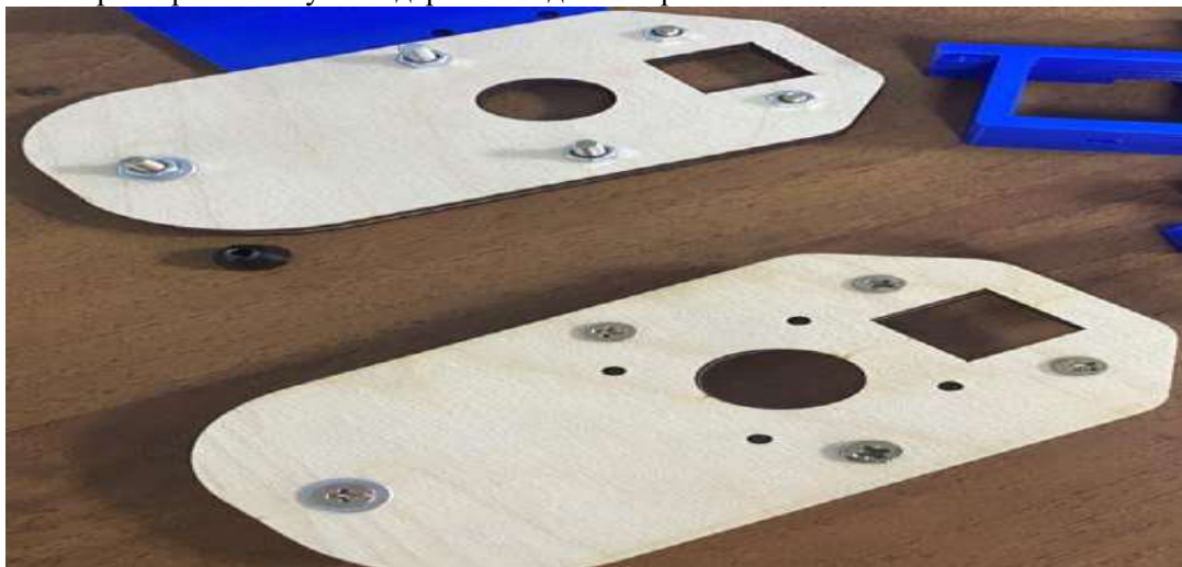
Рис. 2. Держатели для лазера с помощью лазерной резки
