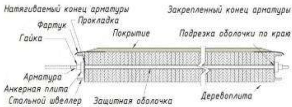
Рис. 2. Конструкция предварительно напряженной многослойной деревоплиты, поперечное сечение
