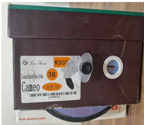
Рисунок 3 - Фотография самодельного спектрометра спереди, показывающая входную щель, DVD-диск с прорезями для регулировки ширины щели (от 5 до 100 мкм), держатель диска. Корпус изготовлен из картона с затемнённой внутренней поверхностью.
