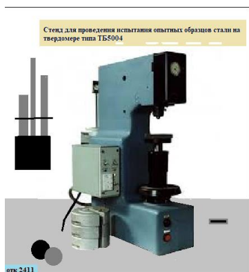
Рисунок 2 - Твердомер типа ТБ5004 для определения твердости стальных образцов
