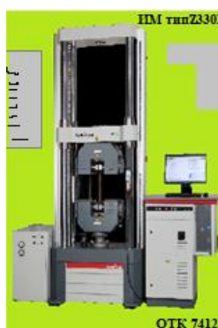
Рисунок 3 - Испытательная машина типа Z330E, где проводят испытание образцов стали на растяжение и разрыв
