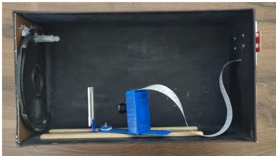
Рисунок 4 - Фотография спектрометра с открытым корпусом сбоку
