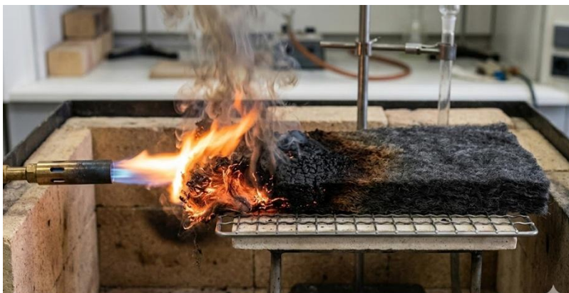
Рисунок 3 - Процесс карбонизации шерстяного мата под воздействием пламени
