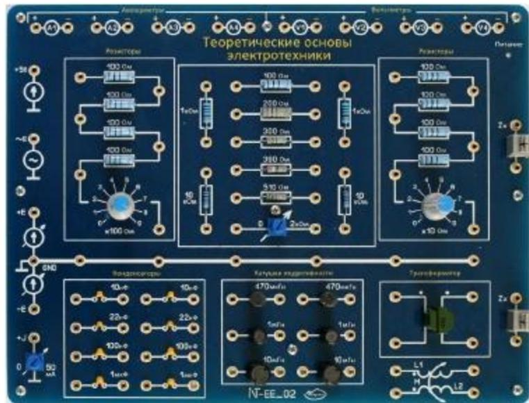
Рис. 2.2-1 Макетная плата
